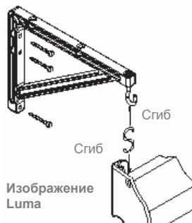
Зафиксируйте на стене кронштейны (не комплектующиеся с экраном), используя принадлежности, описанные выше в параграфе «Крепление на стене». Затем подвесьте экран на S-крюках, продев через передние отверстия. Для повышения надежности согните оба конца S-крюков, таким образом, чтобы экран не мог соскочить.
