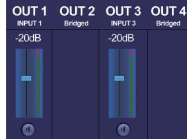
что все каналы усилителя работают независимо, а индикация «ON» – мостовой режим включен.
