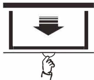
Чтобы опустить экран, легко потяните его за ручку в нижней части до нужного положения. Блокировочный механизм зафиксирует экран в текущей позиции, как только вы перестанете тянуть.
