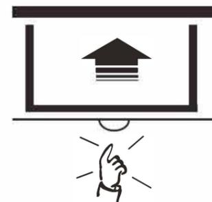
Чтобы свернуть экран, потяните его вниз приблизительно на 1см. После этого возвратный механизм свернет экран автоматически.
