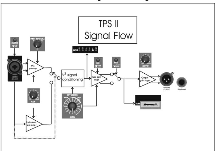
**TPS II™ signal Flow Diagram**
