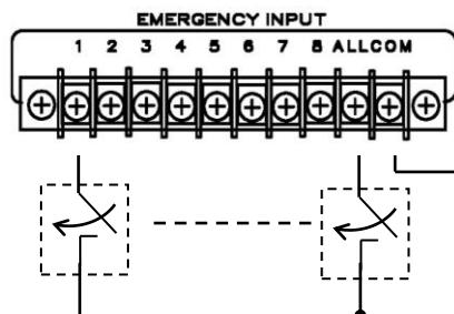
При замыкании клеммы 1-8, и клеммы СОМ включаются соответствующие группы усилителей RA-8236 (см. инструкцию к RA-8236), индикаторы CH1-CH8 (поз.4) загораются красным цветом. Сигнал со входа EM1 поступает на выход блока OUT (поз.16) и на выход усилителя RA-8236 который запрограммирован в соответствующую группу. При этом основной регулятор громкости VOLUME (поз.8) блокируется, регулировка громкости становится возможной только при помощи регулятора EM1 (поз.17).
