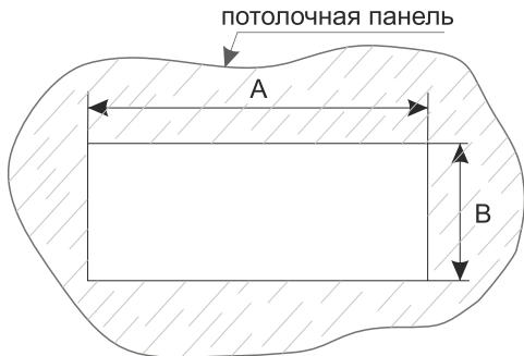
отверстие для установки динамика в стену
