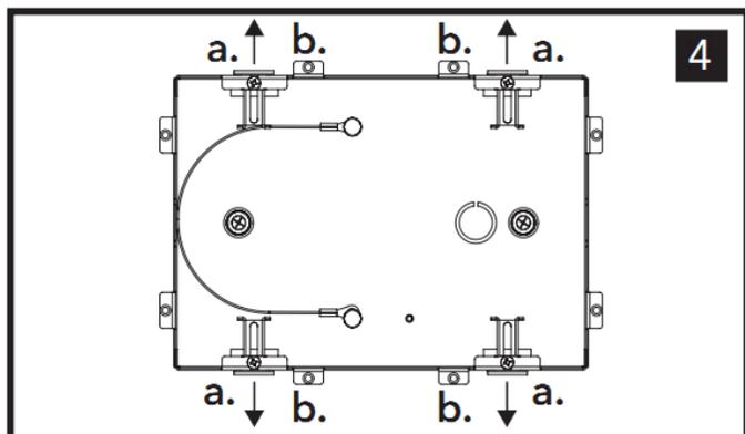
С помощью отвертки раздвиньте крепежные «лапки» до упора. При необходимости более жесткой фиксации, можно прикрутить короб к поверхности с помощью саморезов.
