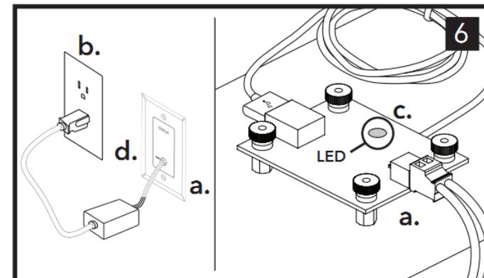
Подключите коннектор кабеля питания к USB плате и настенной плате питания. Вставьте блок питания в настенную плату питания и подключите к розетке. После чего на USB плате должен загореться световой индикатор, подтверждающий, что подключение произведено корректно. Закрепите настенную плату питания с помощью декоративных винтов.
