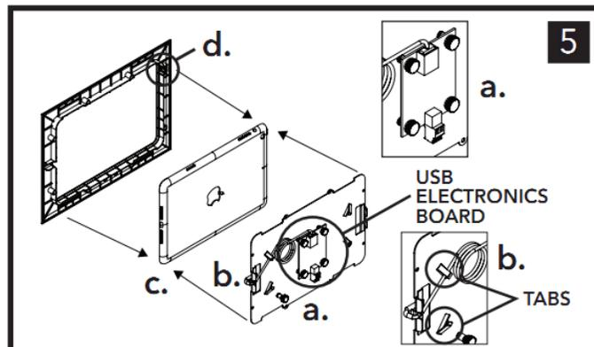
Установите USB плату на заднюю часть фиксирующей пластины. Подключите USB кабель к iPad и USB плате. Оставьте достаточную длину кабеля для установки, остальную кабель сматывайте и зафиксируйте с помощью фиксаторов. Установите iPad между декоративной рамкой и фиксирующей пластиной, закрепите. Убедитесь, что кнопка питания на iPad и панели совпала.
