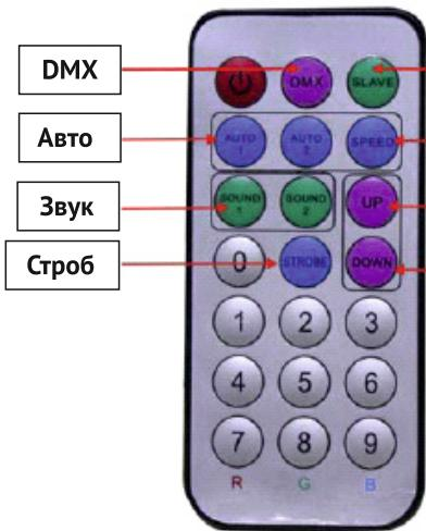
Нажмите клавишу DMX, Ведомый (slave), Авто, Скорость, звук, строб для выбора режима управления. Используйте клавиши ВВЕРХ и ВНИЗ для выбора вариантов. Нажимайте клавиши цифр для выбора различных вариантов в режиме DMX, R,G, B (Красн., Зел., Син.)
