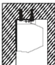
Встроенная установка на расширительные болты
