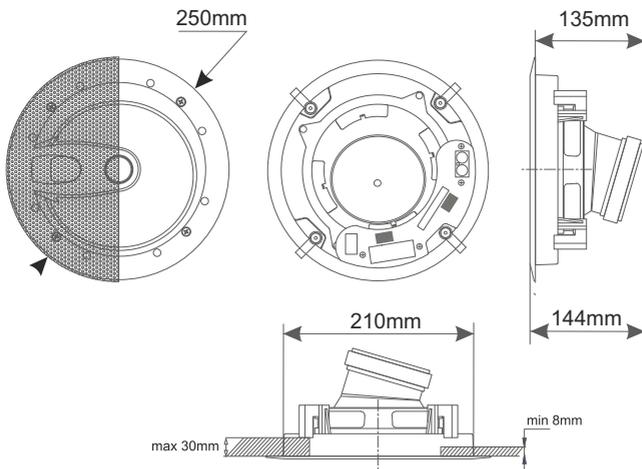
отверстие в подвесном потолке для установки - 210mm
