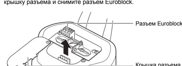
3 Отверткой с плоским жалом ослабьте винты клемм разъема Euroblock. Вставьте кабели в клеммы и затяните винты. Убедитесь, что кабели нельзя извлечь из клемм.
