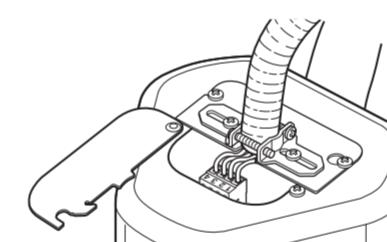
8 Закройте крышку разъема и затяните винт крышки.
