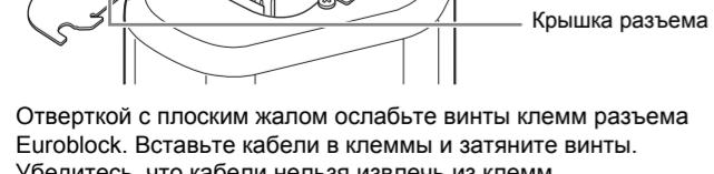
3 Отверткой с плоским жалом ослабьте винты клемм разъема Euroblock. Вставьте кабели в клеммы и затяните винты. Убедитесь, что кабели нельзя извлечь из клемм.
