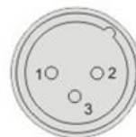
Вход DMX Разъем для подключения XLR (вид сзади)
