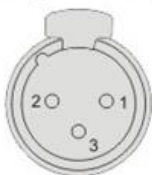
Выход DMX Разъем для подключения XLR (вид сзади)
