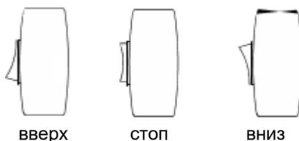
Свертывание экрана: нажмите кнопку переключателя в положении «вверх». В максимально свернутом положении экрана двигатель остановиться автоматически.
