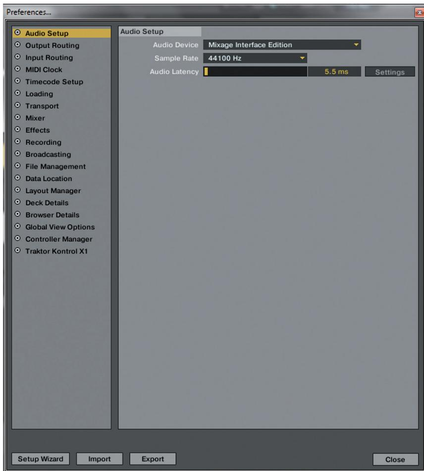
3. Open the category „Output Routing“ and in the field „Mixing Mode“ select the button „Internal“.
