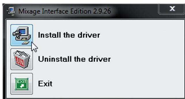
3. Sie werden anschließend aufgefordert, Reloop Mixage anzustecken und einzuschalten. Sollte Reloop Mixage noch nicht per USB verbunden sein, so schließen Sie das mitgelieferte USB-Kabel an Mixage's USB-Port -B42- und einem freien USB-Anschluss Ihres Computers an. Verbinden Sie ebenfalls das mitgelieferte Netzteil mit dem Netzteilanschluss -B40-. Schalten Sie nun das Gerät über den Ein/Aus-Schalter -B41- ein.
