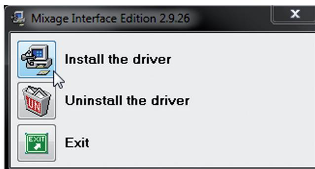
3. L'écran d'installation vous demande alors de connecter et d'allumer votre Reelap Mixage. Si votre Reelap Mixage n'est pas encore raccordé via USB, brancher le câble USB livré au port USB -B42- de votre Mixage et à un port USB libre de votre ordinateur. Brancher également le bloc d'alimentation fourni sur le connecteur du bloc secteur -B40-. Allumer ensuite l'appareil avec l'interrupteur marche/arrêt -B41-.
