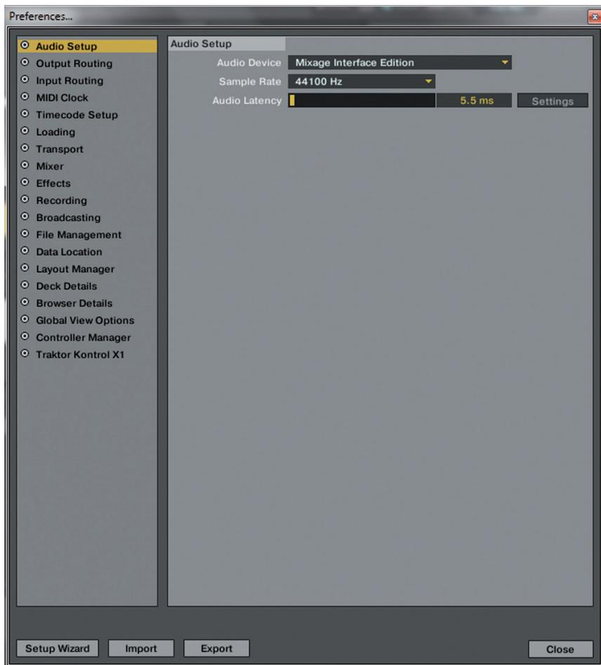
3. Öffnen Sie nun die Kategorie „Output Routing“ und wählen im Bereich „Mixing Mode“ die Schaltfläche „Internal“. Die Kanalzuweisung entnehmen Sie bitte folgendem Beispiel:
