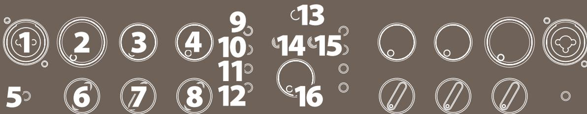
**1** 通道一输入：通道一组合插孔，接受 $\frac{1}{4}$ 寸或XLR输入。在此插入乐器或麦克风；XLR输入为需要幻象电源的麦克风提供电源（请勿使用铝带式麦克风，它可能会被幻象电源损坏）。\*
