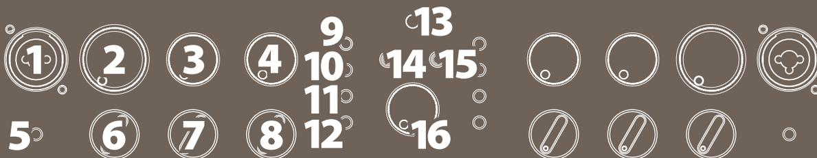
**1** ENTRÉE CHANNEL 1: Cette entrée combinée Jack 6,35 mm/XLR permet de connecter un instrument ou un micro ; le connecteur XLR peut fournir une alimentation fantôme à votre micro si nécessaire (ne pas utiliser de micros à ruban, ceux-ci pouvant être endommagés par la tension fantôme).\*
