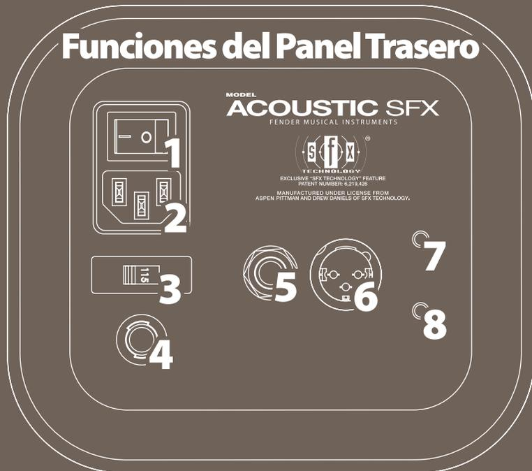
**1** POWER: Interruptor de encendido del Acoustic SFX®.
