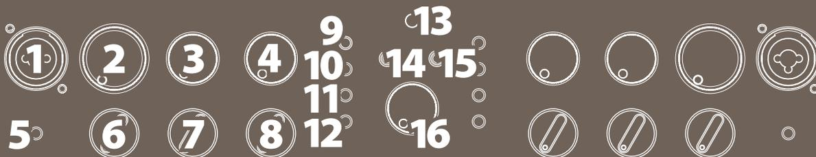
**1** WEJŚCIE KANAŁU 1: Kombinowane gniazdo jack kanału 1 dla wtyków ¼" lub XLR. Tutaj podłącz instrument lub mikrofon. Wejście XLR zapewnia zasilanie fantomowe dla mikrofonów (nie używać mikrofonów wstępowych – zasilanie fantomowe może je uszkodzić).\*
