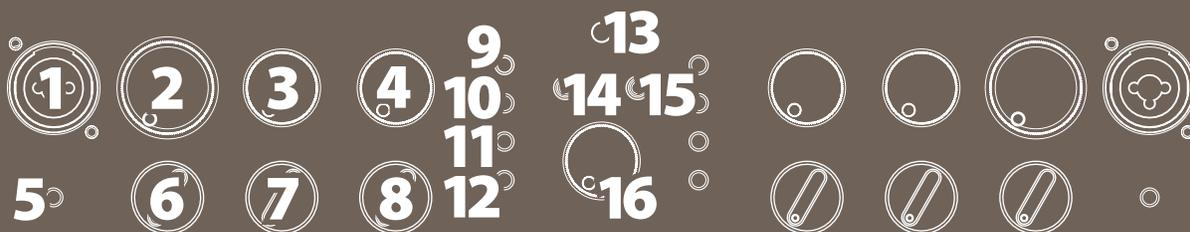
**1** VSTUP PRVÝ KANÁL: Kombinovaný konektor pre prvý kanál akceptuje 1/4-palcové alebo XLR vstupy. Pripojte sem nástroj alebo mikrofón; vstup XLR poskytuje fantómové napájanie pre mikrofóny, ktoré to vyžadujú (nepoužívajte páskové mikrofóny, ktoré sa môžu vplyvom fantómového napájania poškodiť).\*
