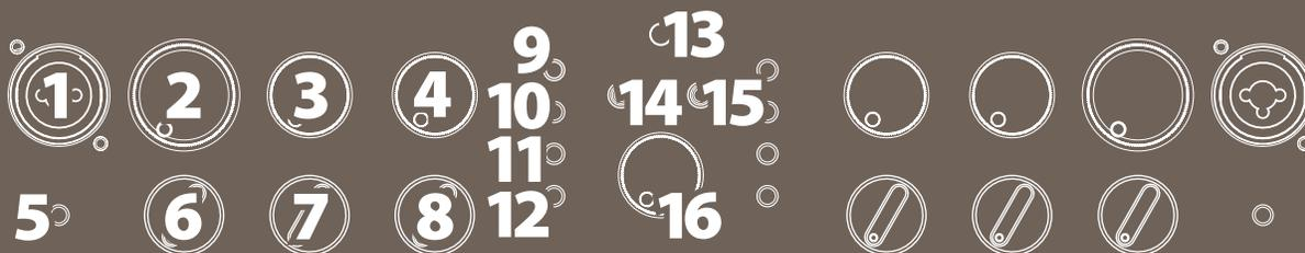
**1** EINGANG KANAL 1: Diese Kombibuchse von Kanal 1 akzeptiert 6,3 mm- und XLR-Stecker von Instrumenten oder Mikrofonen. Der XLR-Eingang liefert bei Bedarf auch Phantomspannung für Mikrofone. (Ribbon-Mikrofone sollte man nicht anschließen, da sie durch Phantomspannung beschädigt werden können).\*
