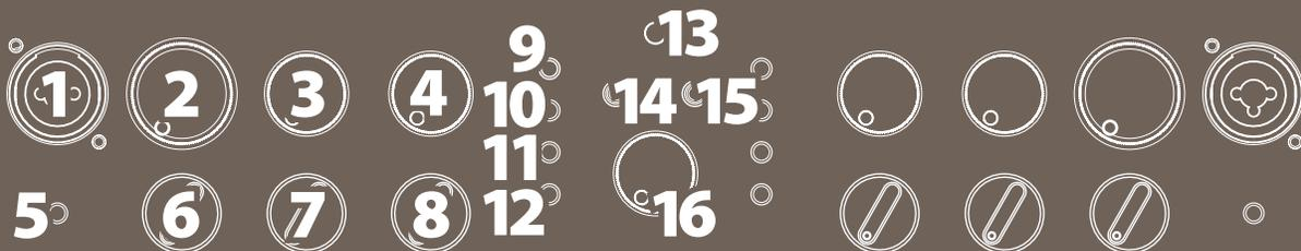
**1** CHANNEL ONE INPUT (チャンネル1入力) : チャンネル1への1/4インチまたはXLR入力が可能な、コンベネーション・ジャックです。楽器またはマイクロフォンをここに接続します；XLR入力は、電源が必要なマイクロフォン用のファンタム電源を装備 (リボンマイクにはファンタム電源は使用しないでください。損傷のおそれがあります) 。
