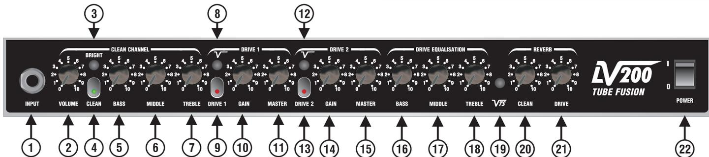
1. 输入插孔。此插座用于连接您的仪器放大器。只有用质量好的屏蔽电缆。
