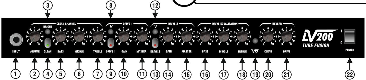
1. Este soquete deve ser usado para conectar seu instrumento ao amplificador. Use apenas cabos de qualidade.
