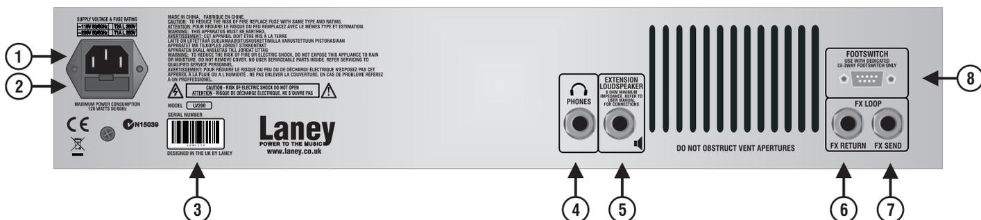
1. 电源插座插座。确保指定的电压为你的国家是正确的！
