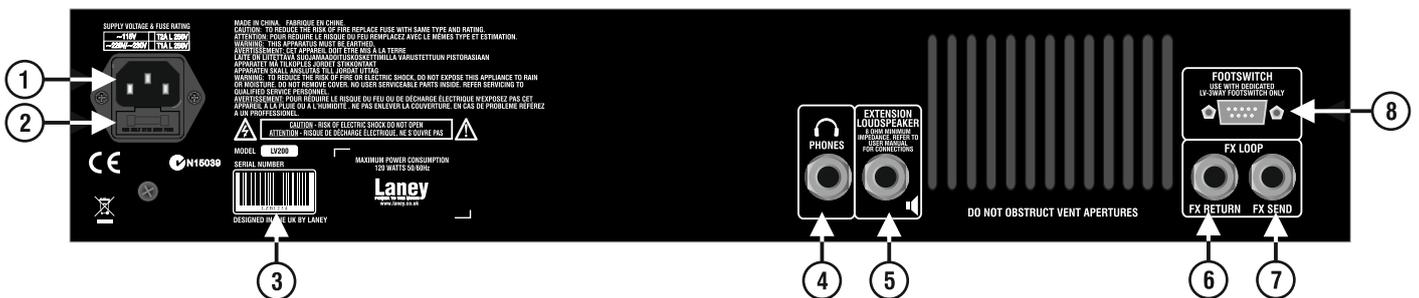
1. Entrada AC. Conecte sua fonte de energia aqui. Certifique-se de que a voltagem local corresponda com a voltagem do amplificador!
