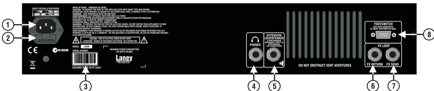
1. Toma de entrada de alimentación. Conéctelo a la fuente de alimentación eléctrica. Asegúrese de que el voltaje especificado es el adecuado para el país en el se va a utilizar.
