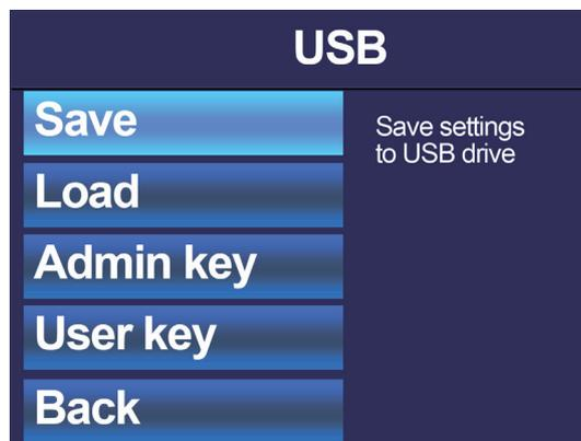
Эти файлы содержат, помимо вышеперечисленных параметров АС, также сведения об оптимальных настройках фильтров, эквалайзеров, мостовых подключений и т. п. Дополнительные сведения о системе отображаются в выбранном окне с правой стороны. При выборе файлы типа \*.SOL загружаются в процессор усилителя сразу, не требуя выбора каналов, в которых эта настройка будет применяться.
