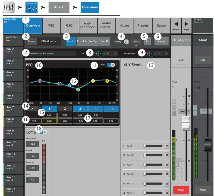
**ПРИМЕЧАНИЕ:** Данная секция отображает компрессор или лимитер в зависимости от выбора в меню канала.
