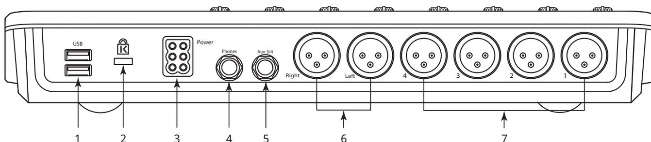
1. **Коннектор USB 3.0, тип A** – подключение USB накопителей, MIDI<sup>®</sup> ножных контроллеров, и Wi-Fi адаптера.
