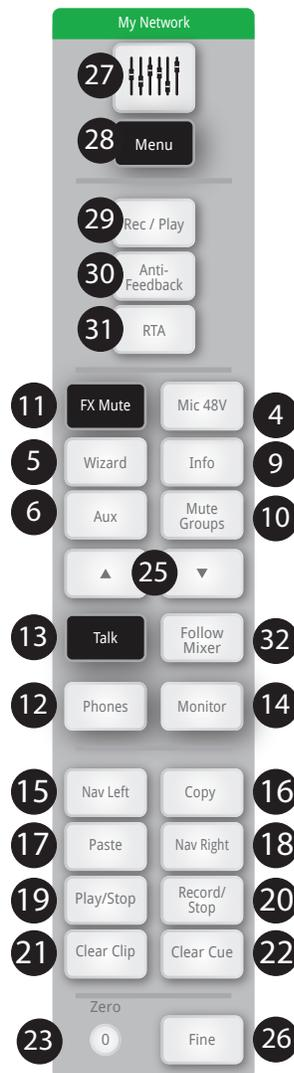
32. **Кнопка Follow Mixer** – В этом режиме удаленное устройство переходит в режим просмотра текущего канала. При изменении текущего канала на микшере аналогичное переключение происходит на устройстве. Можно переключаться на любой экран. Также можно выбрать параметр на устройстве и вносить изменения с помощью мастер энкодера.
