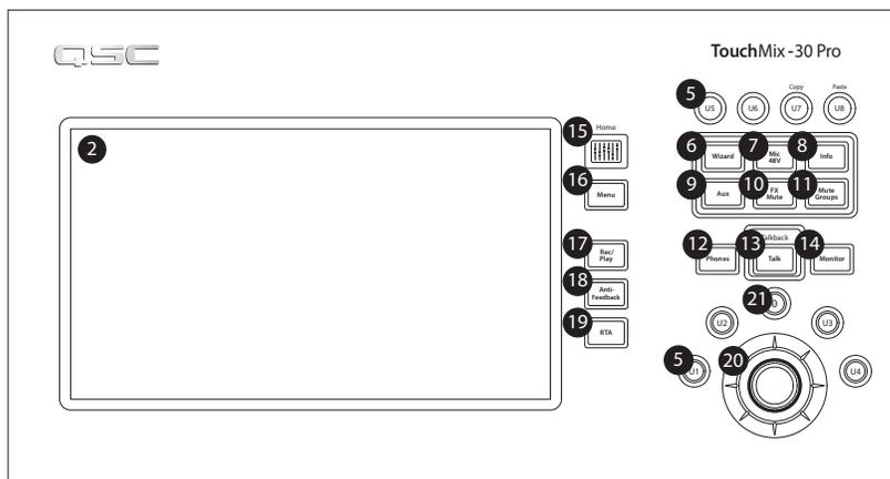
6. **Кнопка Wizard** – Включение Помощника. Список помощников: FX Wizard (помощь в настройке эффектов), Tuning Wizard (помощь в настройке), Gain Wizard (помощь в настройке чувствительности).
