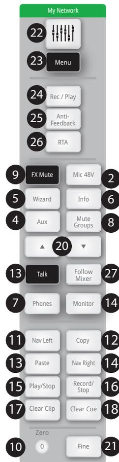
26. **Кнопка RTA** – Отображение одного из двух анализаторов спектра RTA. Доступен только один анализатор, он может отображаться либо на микшере, либо на удаленном устройстве, но не одновременно.
