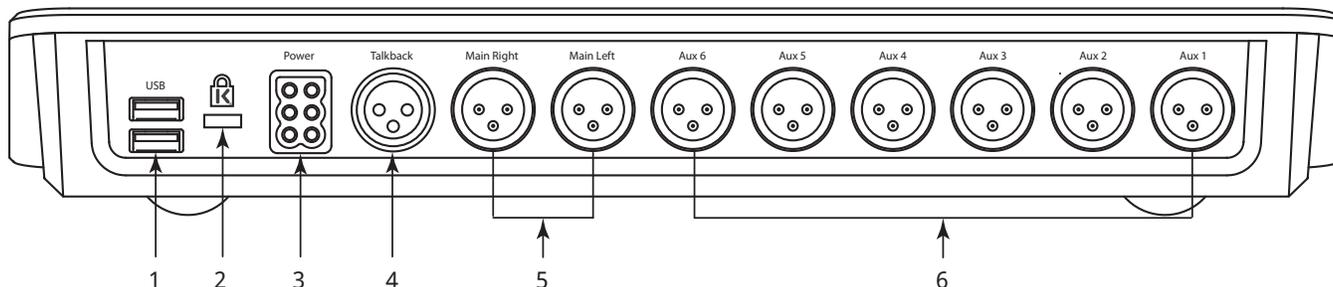
1. **Коннектор USB 3.0, тип A** – подключение USB накопителей, MIDI<sup>®</sup> ножных контроллеров, и Wi-Fi адаптера.
