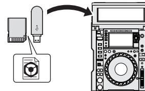
Подключите устройство хранения (SD, USB) к DJ проигрывателю.
