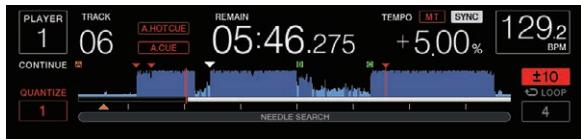
По достижении установленной точки автоматически устанавливается петля и запускается воспроизведение петли.
