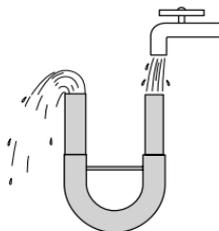
**Внимание!** При очистке внутренних частей pedalной трубы никогда не разбирайте вентили. Также при промывке трубок водой пропускайте воду через настроечные кроны в направлении, противоположном потоку воздуха. Если пропускать воду через инструмент со стороны мундштучной трубки из-за чего они могут перестать работать.
