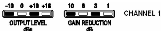
2. Последовательное нажатие на кнопку **<AFS>** в секции канала 1 обеспечивает переключение между тремя различными меню. При этом загораются различные светодиоды индикатора OUTPUT LEVEL CHANNEL 1:
