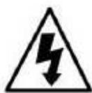
Изображение в виде молнии, находящейся в равностороннем треугольнике, предназначено для того, чтобы предупредить пользователя о наличии неизолированных источников высокого напряжения в корпусе устройства, количество которых может быть достаточным для предупреждения о риске поражения электрическим током.
