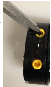
"DOWN" Limit "AB" Grenze Vis de réglage de limite inférieure
