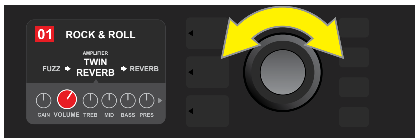
Rode novamente o ENCODER para ajustar o knob digital de controlo de amplificador seleccionado para o valor pretendido.
