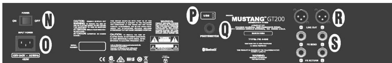
La figure montre le panneau arrière du Mustang GT100/GT200. Le panneau arrière de l'amplificateur Mustang GT40 ne possède pas les prises R et S.
