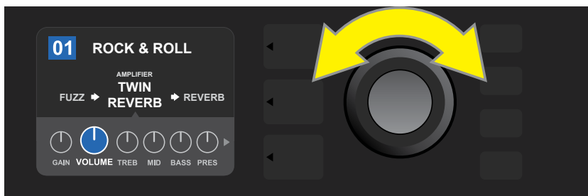
Rode o ENCODER para navegar entre knobs digitais de controlo de amplificador.
