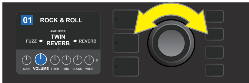
Ruotare l'ENCODER per scorrere tra le manopole di controllo del modello di amplificatore.
