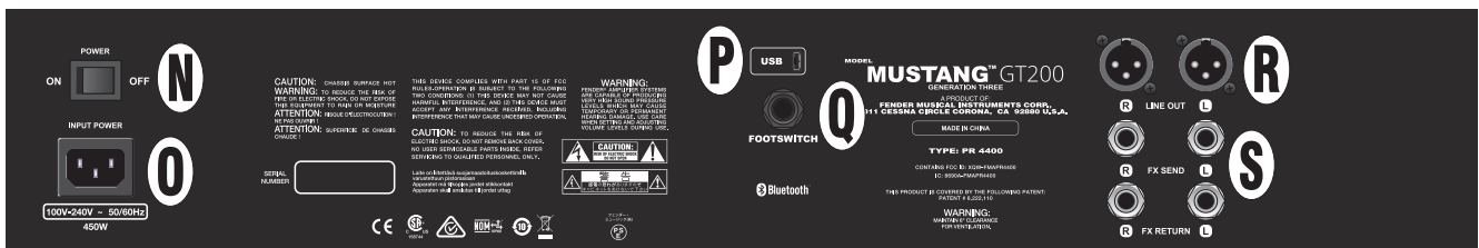
上の図はMustang GT100/GT200の背面パネルです; Mustang GT40の背面パネルはN, O, P およびQのみです。
