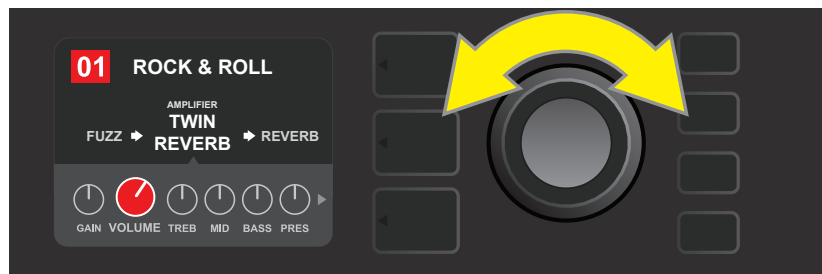
Ruotare nuovamente l'ENCODER per regolare la manopola di controllo del modello di amplificatore selezionato secondo le preferenze.
