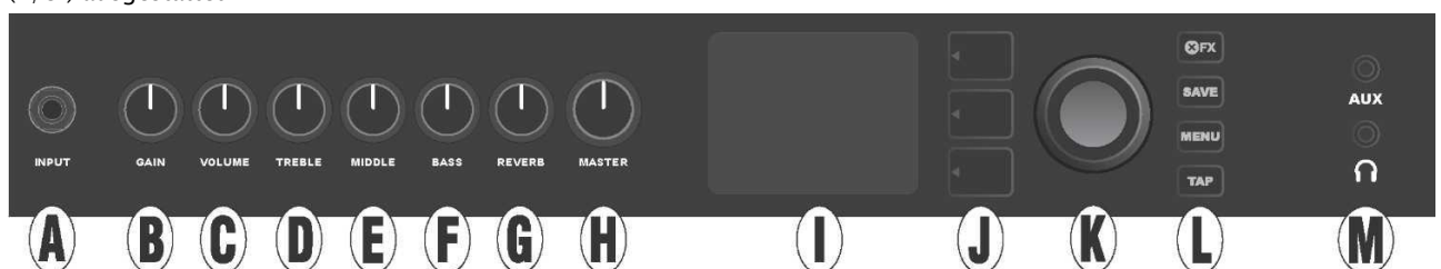
Bedienfeld für den Combo Mustang GT100/GT200 mit sieben Bedienknöpfen, der Combo Mustang GT40 ist mit fünf Bedienknöpfen (Gain, Volume, Treble, Bass, Master Volume) ausgestattet.
