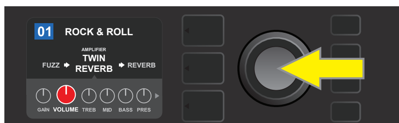
Premere l'ENCODER per selezionare una manopola di controllo del modello di amplificatore per la regolazione.
