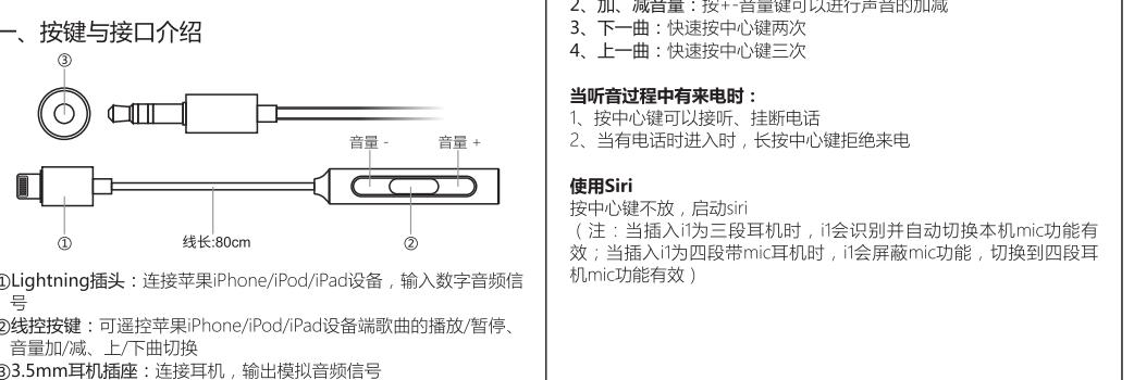
①Lightning插头：连接苹果iPhone/iPod设备，输入数字音频信号
