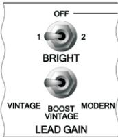
BRIGHT – придает звуку более яркую и звонкую окраску с выделением верхней середины. Диапазон средних частот увеличивается от режима 1 к режиму 2. Структура этого регулятора идентична структуре BRIGHT на CLEAN CHANNEL. Регулятор также содержит три режима: OFF, 1 и 2. Но практическое значение BRIGHT на LEAD CHANNEL сводится к тому, что он выполняет функцию эквалайзера на входе преампа. При выключенном BRIGHT (когда регулятор находится в положении OFF) звук становится мягким и
