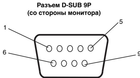
Данный ЖК-монитор использует линии RXD, TXD и GND для управления RS-232C.
