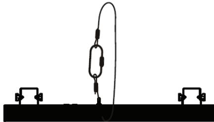
\* *Замечание.* При установке светодиодный модуль можно ориентировать под любым углом. В дальнейшем для изменения угла наклона используются два зажима, расположенные по бокам прибора.
