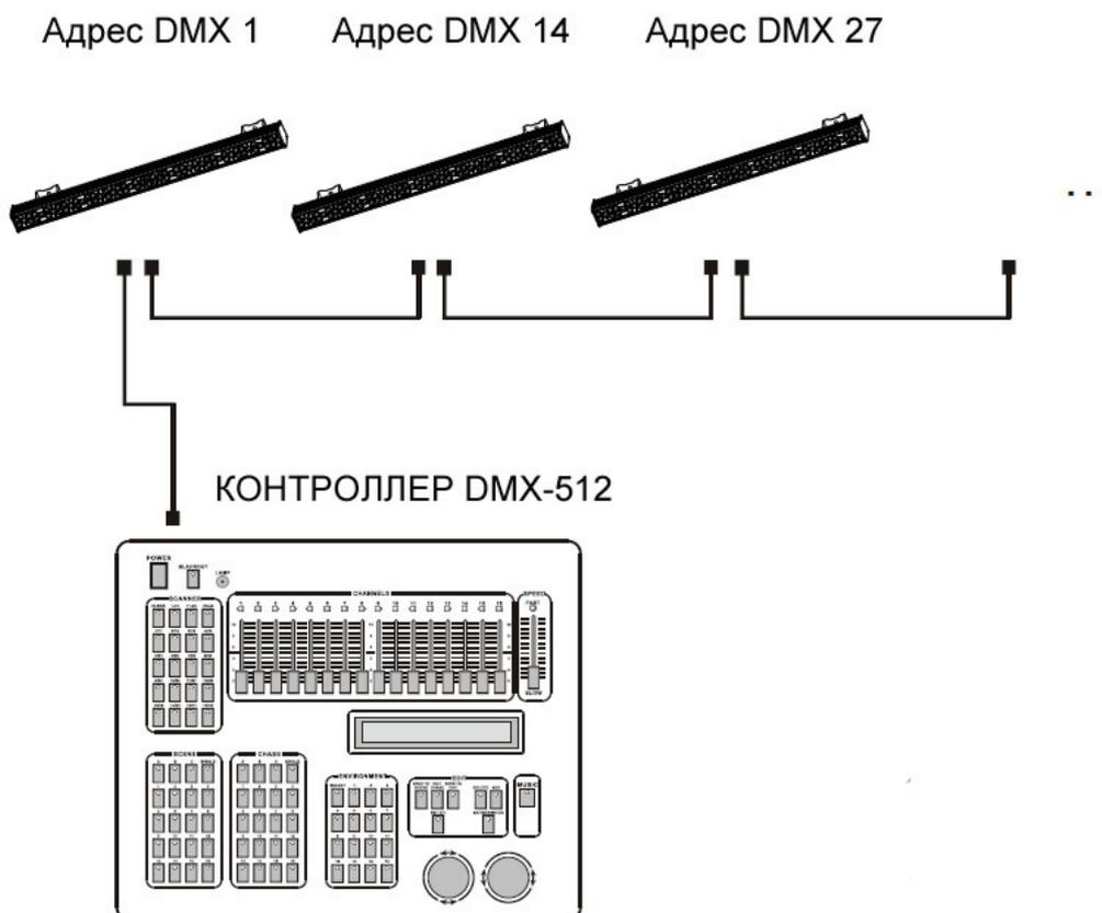
На рисунке показан простой вариант подключения, в котором для первого устройства в цепи выбран адрес 1, для второго — 14 и т. д. Обратите внимание, в данном режиме канал 12 не должен использоваться (CH12=0).
