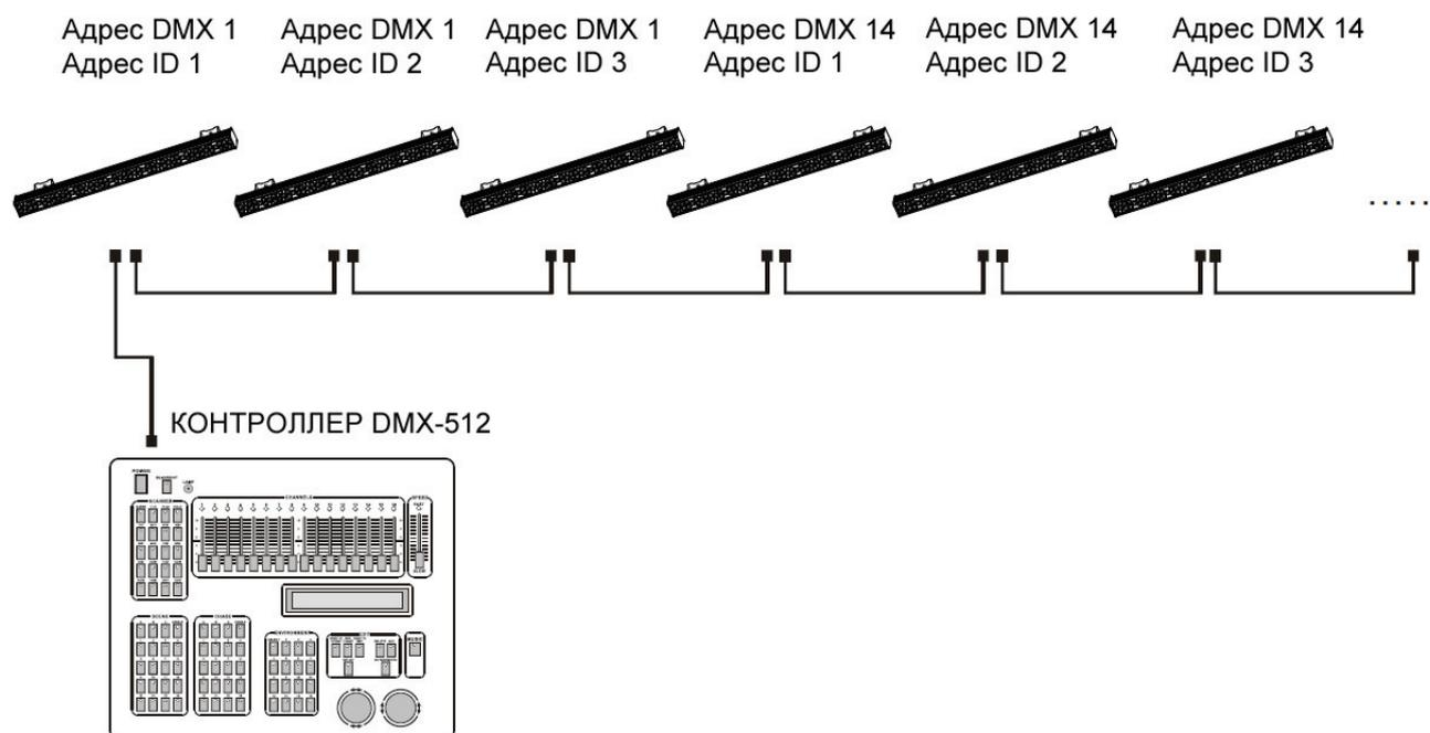
На рисунке показан простой вариант подключения, в котором каждому DMX-адресу соответствуют 3 устройства. Трём устройствам соответствуют 3 различных ID-адреса. Таким образом, оператор может управлять всеми устройствами одновременно (CH12=0) или, выбрав DMX-адрес и используя канал 12 для выбора ID-адреса, управлять отдельно каждым устройством.
