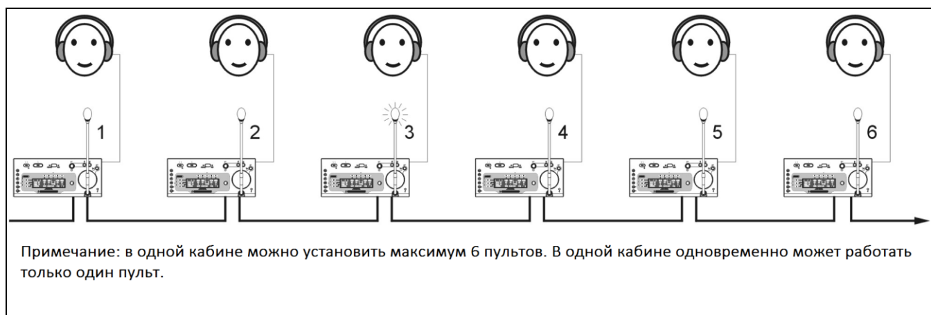
Рис. 4.4.3 Схематическая диаграмма подключения пультов переводчика
