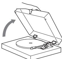
**⚠ Var försiktig att du inte klämmer din hand när du t. ex. öppnar och stänger dammskyddet.**
