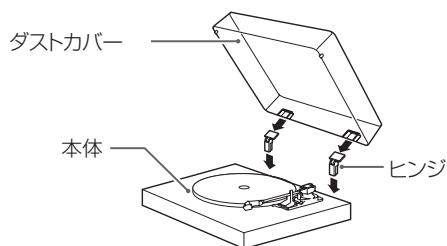
**1** 本体背面の左右両端にあるヒンジ差し込み部にヒンジを合わせて、奥までめ込みます。
