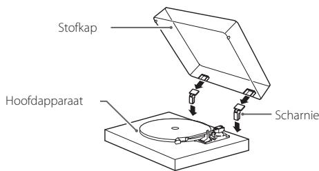
**1 Steek de scharnieren volledig in de scharnierhouders aan de linker en rechter achterkant van het hoofdapparaat.**
