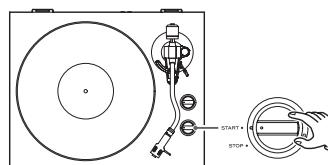
• Wenn Sie den Drehknopf START/STOP auf die Position START stellen, beginnt sich der Plattensteller zu drehen. Gleichzeitig leuchtet die blaue START Anzeige.
