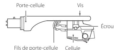
**4 Raccordez les contacts du porte-cellule à la cellule.**
