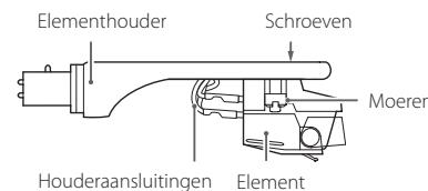
**4 Sluit de aansluitingen van de elementhouder aan op het element.**
