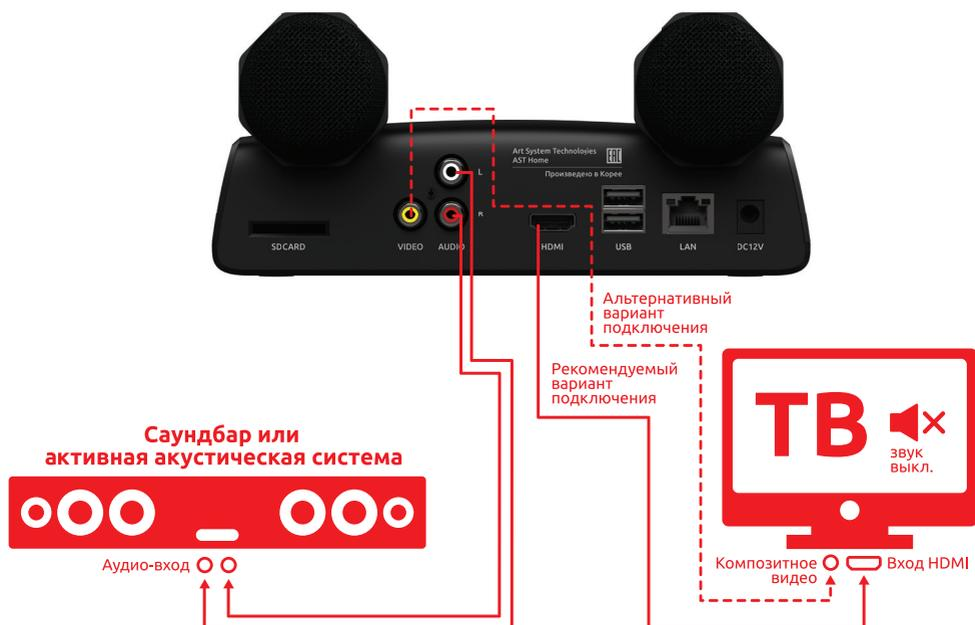
Рис. 4. Примерная схема подключения к активной акустической системе
