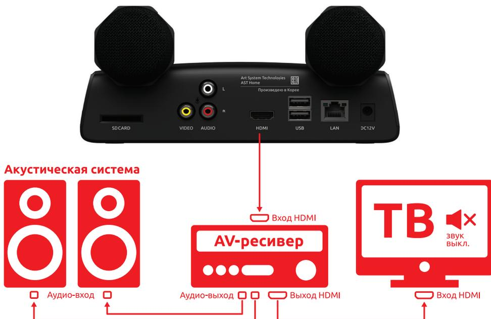
**Рис. 2.** Примерная схема подключения к ресиверу домашнего кинотеатра
