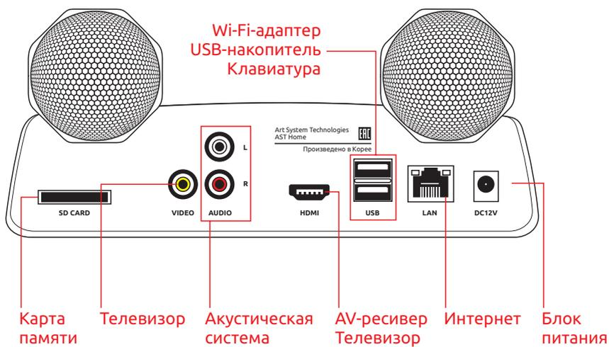
**Рис. 1.** Разъёмы караоке-системы
