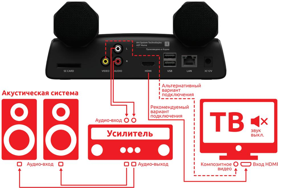
**Рис. 3.** Примерная схема подключения к пассивной акустической системе
