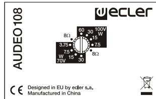
Les 4 positions du sélecteur de puissance pour une ligne de 100 V permettent de configurer la puissance de fonctionnement maximale de chaque unité. Ainsi, dans les endroits où un faible niveau sonore est souhaité, on utilise les positions inférieures 7,5 à 15 W, tandis que, dans les endroits où il est souhaité un niveau sonore supérieur, on utilise les positions supérieures 30 ou 60 W.
