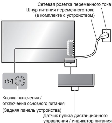
При работе направляйте пульт дистанционного управления непосредственно на датчик пульта дистанционного управления устройства.
