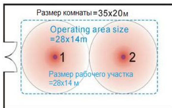
Рис. 3.12 Два трансивера покрывают всю рабочую зону
