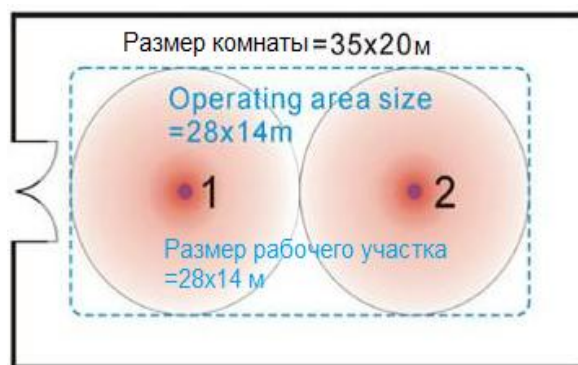
Рис. 3.12 Два трансивера покрывают всю рабочую зону
