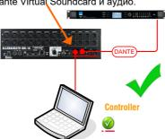
Дополнительный порт Gigabit Ethernet, запирающийся разъем Ethercon RJ45. Может использоваться для резервирования, чтобы обеспечить резервное кабельное соединение, когда карта находится в режиме резервированияк
