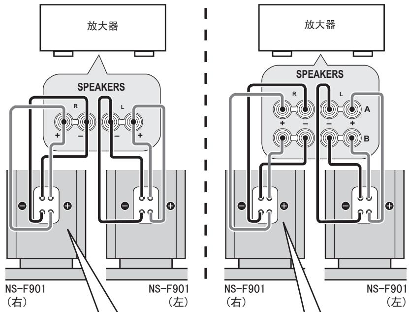
在连接之前拔下跨接缆线。
