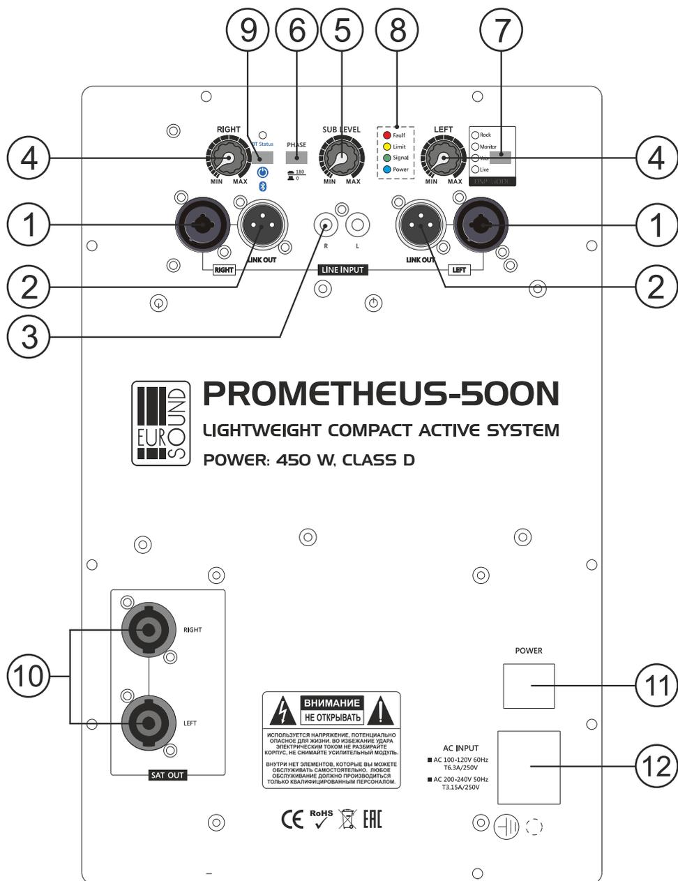
1. Линейный балансный вход на разъемах XLR для подключения источника сигнала, например, микшерного пульта.
