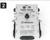
电池检测: 将拨动旋钮拧到最右边一挡检测电池,如果"Battery Check"绿色灯亮起来,表示电池供电正常,测线器能正常工作。如果不亮,请重新打开电池盒,查看电池极性是否装反或电池是否有电。
