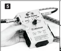
检测线材(二):再把拨动旋钮拧到"2"和"3"的位置,如果LED灯——对应亮起,说明这条线材的"PIN2"和"PIN3"连接正常。如果交叉亮或者有灯不亮说明线材连接错误。按照此步骤可以检测其它线材。
