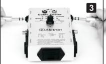
连接线材:将需要测试的线材插入测线器对应的插孔中。
