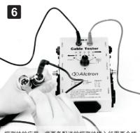
探测线的应用:将两条配送的探测线插入红黑两个插孔内,如果探测缮两段直接接通会出现、滴滴"的蜂鸣声并且黄色LED亮起,使用此方法可以检测在测线器上没有对应插孔的音频线。用探测笔连接对应线材端口,如出现蜂鸣声表示线材连通。
