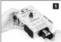
安装电池:打开测线器底部的电池盖,将配送的9V电 池根据电池盒上"+""—"标记安装电池,然后推入 电池盒仓内,然后用力往下按,听到"滴"的一声后 说明电池已经紧锁。
