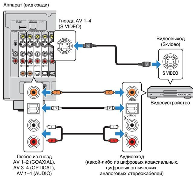
Если в качестве источника входного сигнала аппарата при помощи пульта ДУ выбрать AV 1-4, видео/аудиосигнал, который воспроизводится на видеоустройстве, будет выводиться через аппарат.
