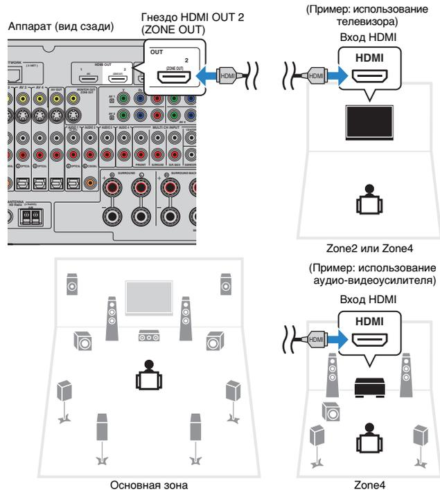
Чтобы назначить гнездо HDMI OUT 2 (ZONE OUT) для Zone2 или Zone4, установите параметру “Назнач. HDMI OUT2” (с. 127) в меню “Настройка” значение “Zone2” или “Zone4”.
