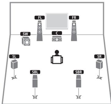
Используя фронтальные колонки, центральную колонку и колонки окружающего звучания, система автоматически создает Virtual Presence Speaker (VPS) для воссоздания объемного звукового поля, а тыловые колонки окружающего звучания позволят вам насладиться эффектом расширенного окружающего звучания.
