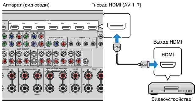
Если в качестве источника входного сигнала аппарата при помощи пульта ДУ выбрать AV 1–7, видео/аудиосигнал, который воспроизводится на видеоустройстве, будет выводиться через аппарат.
