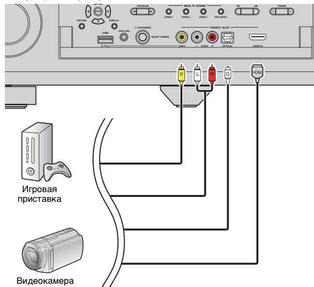
Если в качестве источника входного сигнала аппарата, нажав V-AUX на пульте ДУ, выбрать “V-AUX”, видео/аудиосигнал, который воспроизводится на видеоустройстве, будет выводиться через аппарат.
