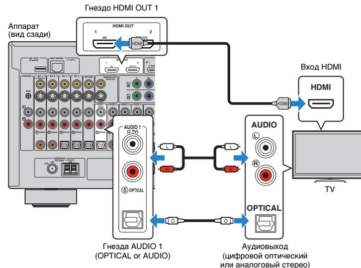
Если в качестве источника входного сигнала аппарата выбрать "AUDIO 1", нажав на пульте ДУ AUDIO 1 или SCENE(TV), звук с телевизора будет воспроизводиться через аппарат.
