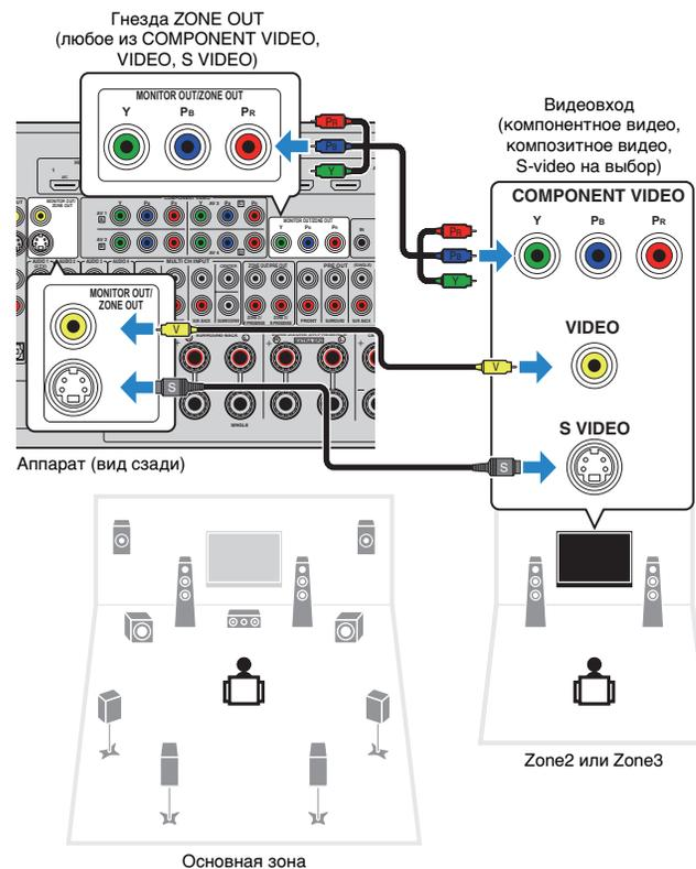
Чтобы назначить гнезда MONITOR OUT/ZONE OUT видеомонитору для Zone2 или Zone3, параметру “Назнач. выход монитора” (с. 126) в меню “Настройка” установите значение “Zone2” или “Zone3”.
