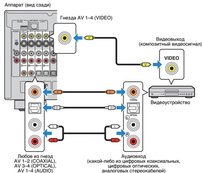
Если в качестве источника входного сигнала аппарата при помощи пульта ДУ выбрать AV 1-4, видео/аудиосигнал, который воспроизводится на видеоустройстве, будет выводиться через аппарат.
