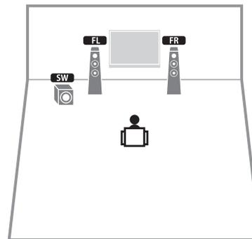
Даже если колонки окружающего звука не подключены, аппарат создает виртуальные колонки окружающего звучания, используя фронтальные колонки, что позволяет наслаждаться многоканальным окружающим звучанием (Virtual CINEMA DSP).
