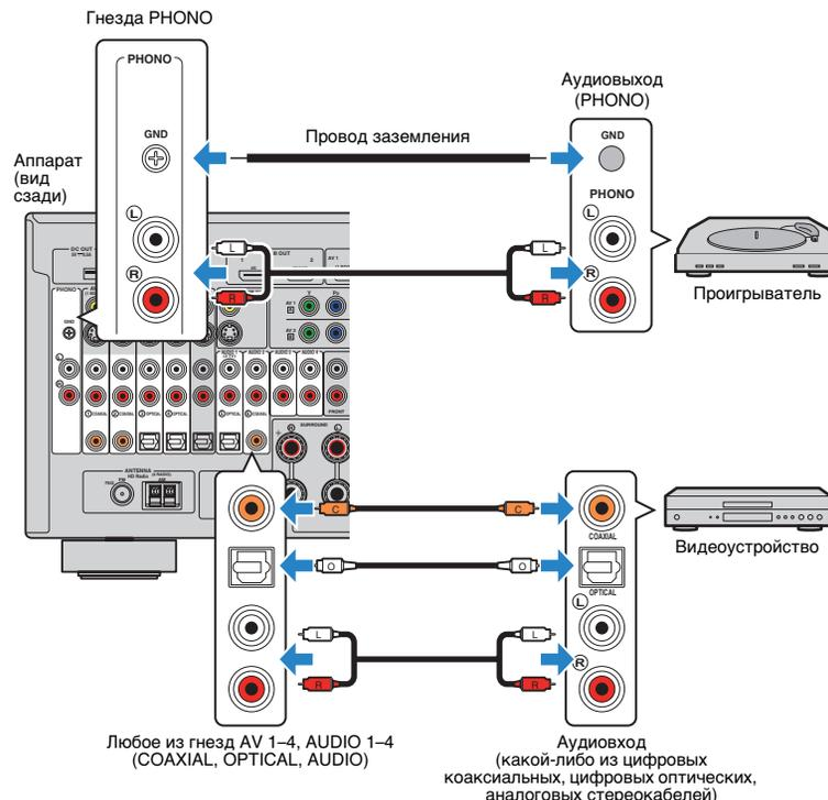
Если выбрать источник входного сигнала с помощью кнопок AV 1–4, AUDIO 1–4 или PHONO на пульте ДУ, аудиосигнал, воспроизводимый аудиоустройством, будет выводиться через аппарат.
