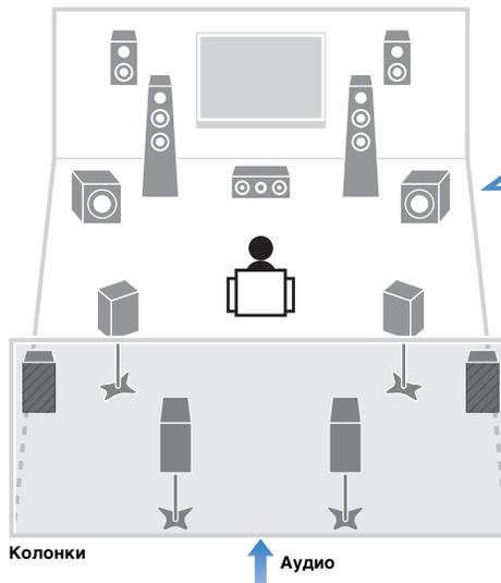
Поддерживает системы колонок с числом каналов от 2 до 9 (с задними колонками присутствия) и подключение до 2 сабвуферов. Позволяет наслаждаться любимыми акустическими пространствами в различных стилях.
