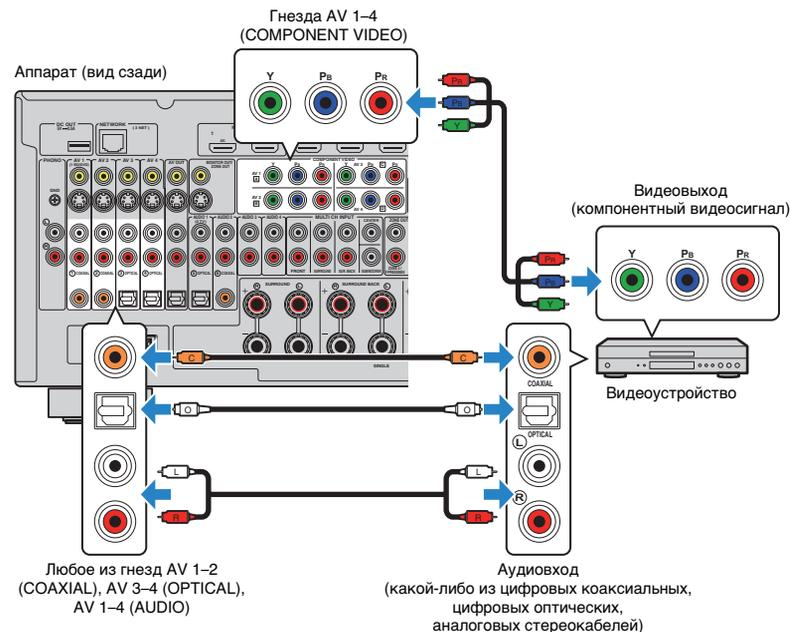
Если в качестве источника входного сигнала аппарата при помощи пульта ДУ выбрать AV 1–4, видео/аудиосигнал, который воспроизводится на видеоустройстве, будет выводиться через аппарат.
