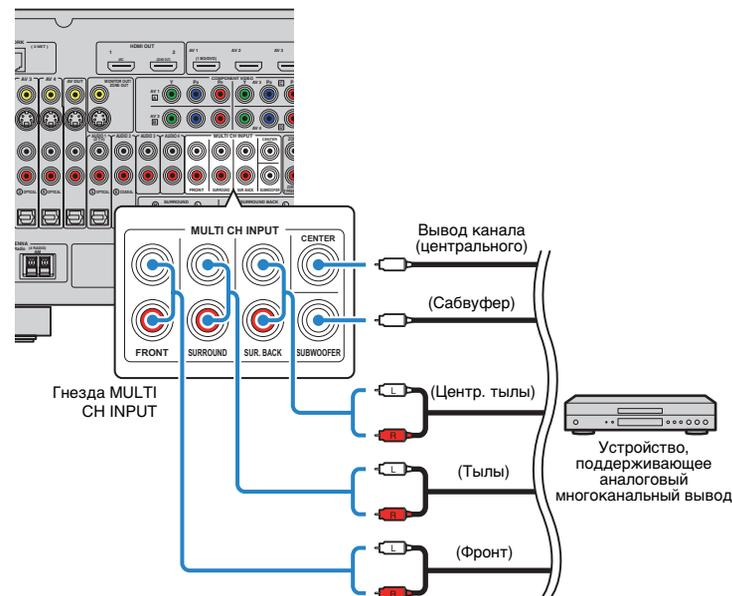
Если в качестве источника входного сигнала аппарата, нажав MULTI на пульте ДУ, выбрать "MULTI CH", аудиосигнал, который воспроизводится на видеоустройстве, будет выводиться через аппарат.
