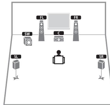
Используя фронтальные колонки, центральную колонку и колонки окружающего звучания, эта система автоматически создает Virtual Presence Speaker (VPS) для воссоздания объемного звукового поля и подходит для воспроизведения содержимого с 5.1-канальным звуком.
