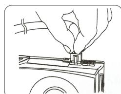
6. 请将SATA电源线连接所有数据驱动器或者光驱(HDD, SSD, ODD)上。
