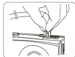
6. Подключите кабель питания SATA ко всем дискам данных или оптическим приводам (HDD, SSD, ODD).
