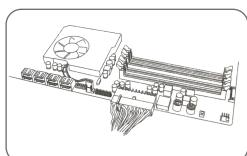
4. Verbinden Sie das 4- + 4-polige -Kabel mit der Hauptplatine.
