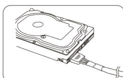
7. 팬, 펌프, 레거시 구성 요소 및 기타 장치 / 어댑터 용 주변 장치 "Molex" 4 핀 커넥터를 연결합니다.
