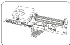
4. Conecte el cable 4 + 4 Pin a la placa base.
