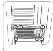
Note : Il est possible d'installer le bloc d'alimentation en orientant la partie avec le ventilateur PSU vers le bas.
