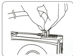
6. Conecte el cable de alimentación SATA a todos los discos de datos o unidades ópticas (HDD, SSD, ODD).
