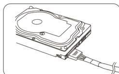
7. Conecte el conector "Molex" 4 pines, un dispositivo periférico para ventilador, bomba, componentes heredados y otros dispositivos o adaptadores.
