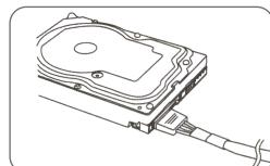
7. Connecter le câble "Molex" 4 pin aux périphériques (ventilateurs, pompes, composants legacy et autres) en utilisant l'adaptateur.
