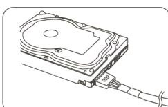
7. 将风扇，泵，传统组件和其他设备/适配器外围设备连接"Molex"4针插口。
