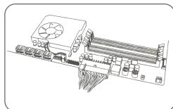
4. 请将4 + 4 Pin 电缆连接到主板上。
