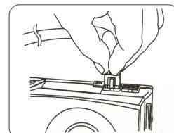
6. SATA電源ケーブルを全てのデータドライブ、または光学ドライブ(HDD, SSD, ODD)に接続してください。
