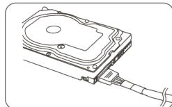
7. 将风扇，泵，传统组件和其他设备/适配器外围设备连接"Molect"4针插口。
