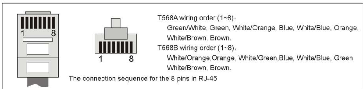
T568B Wiring Scheme
