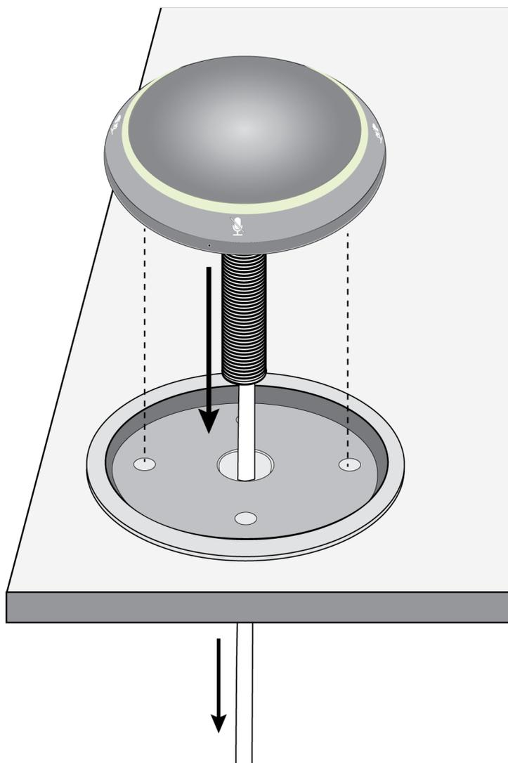
6. Разместите кронштейн под столом, чтобы трубка проходила через отверстие. Для столов с более толстыми столешницами ( $\geq 55$  мм), переверните кронштейн для обеспечения дополнительного зазора.
