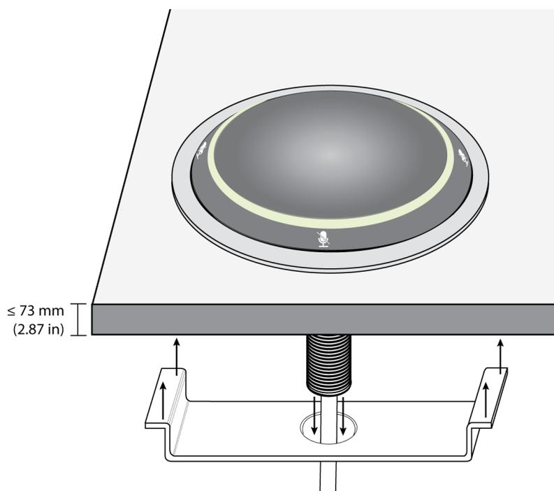
7. Пропустите кабель через крыльчатую гайку и наверните ее на трубку под столом. После этого затяните крыльчатую гайку, чтобы зафиксировать кронштейн на столе.
