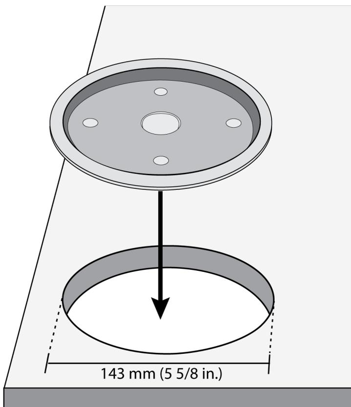
5. Пропустите кабель через отверстие в центре подставки. После этого пропустите трубку через отверстие в столе и аккуратно прижмите микрофон к подставке. Совместите логотип Shure на микрофоне с логотипом Shure на подставке. Четыре резиновых ножки в нижней части микрофона входят в четыре небольших отверстия на подставке.
