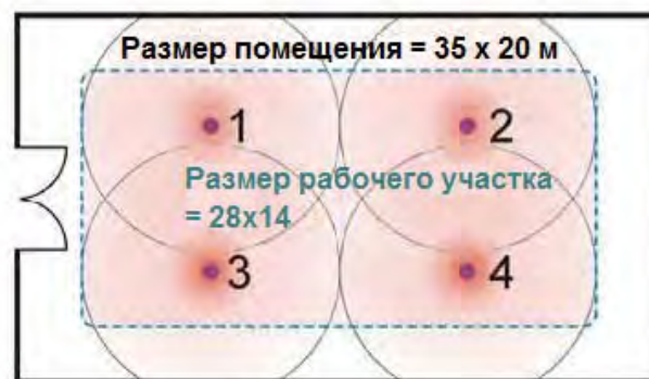
Рис. 3.14. Четыре трансивера покрывают всю рабочую зону
