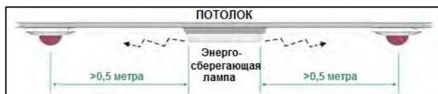
Рис. 3.8. Расположение цифрового инфракрасного трансивера/приемника (поблизости от осветительного оборудования)
