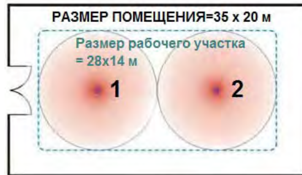
Рис. 3.13. Два трансивера не способны покрыть всю рабочую зону
