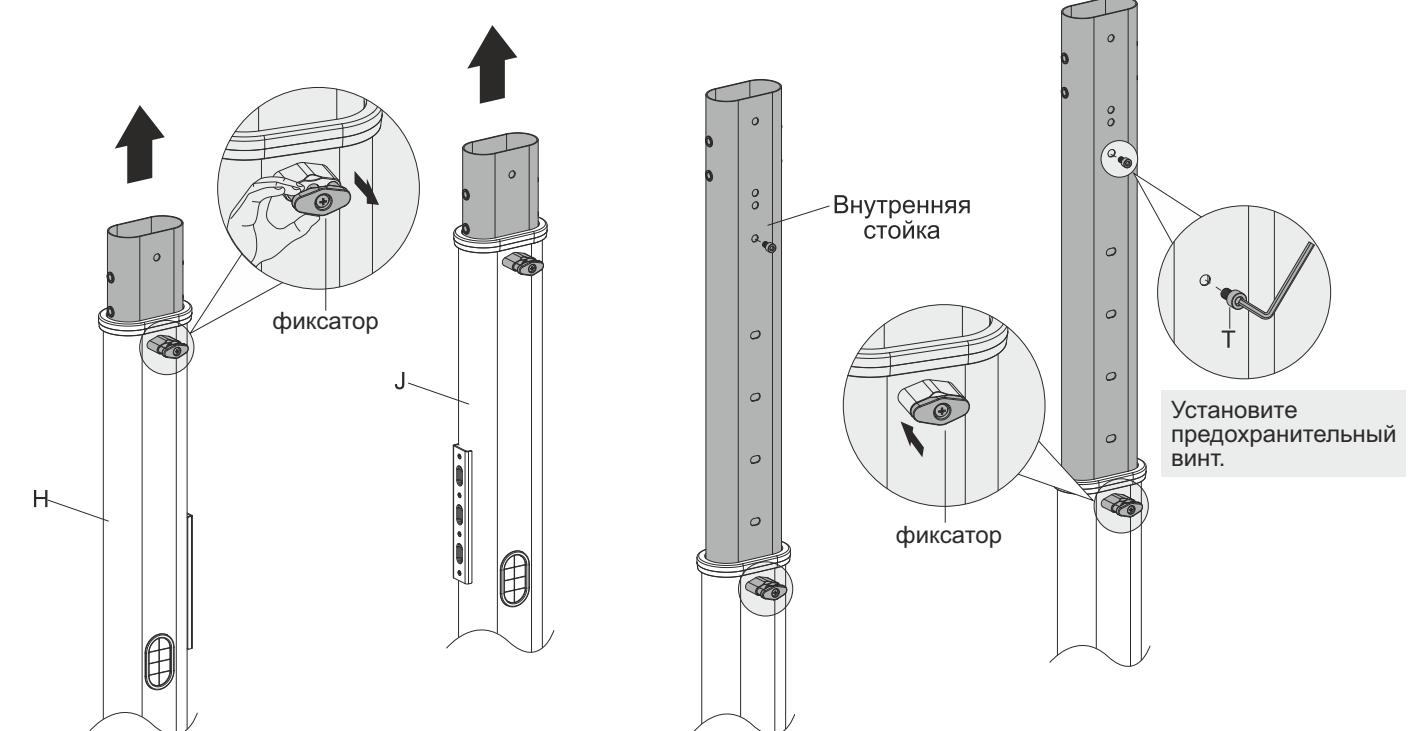
Потяните фиксатор на себя для разблокировки возможности изменения высоты ТВ. После окончания регулировки отпустите фиксатор и убедитесь в том, что он зафиксировался в ответствующем пазе.
