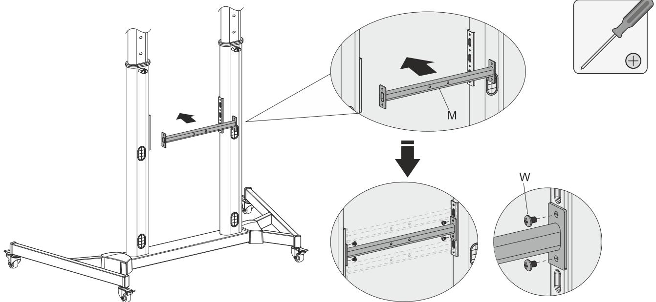
Закрепите опорную штангу между вертикальными опорами на необходимой высоте при помощи винтов.
