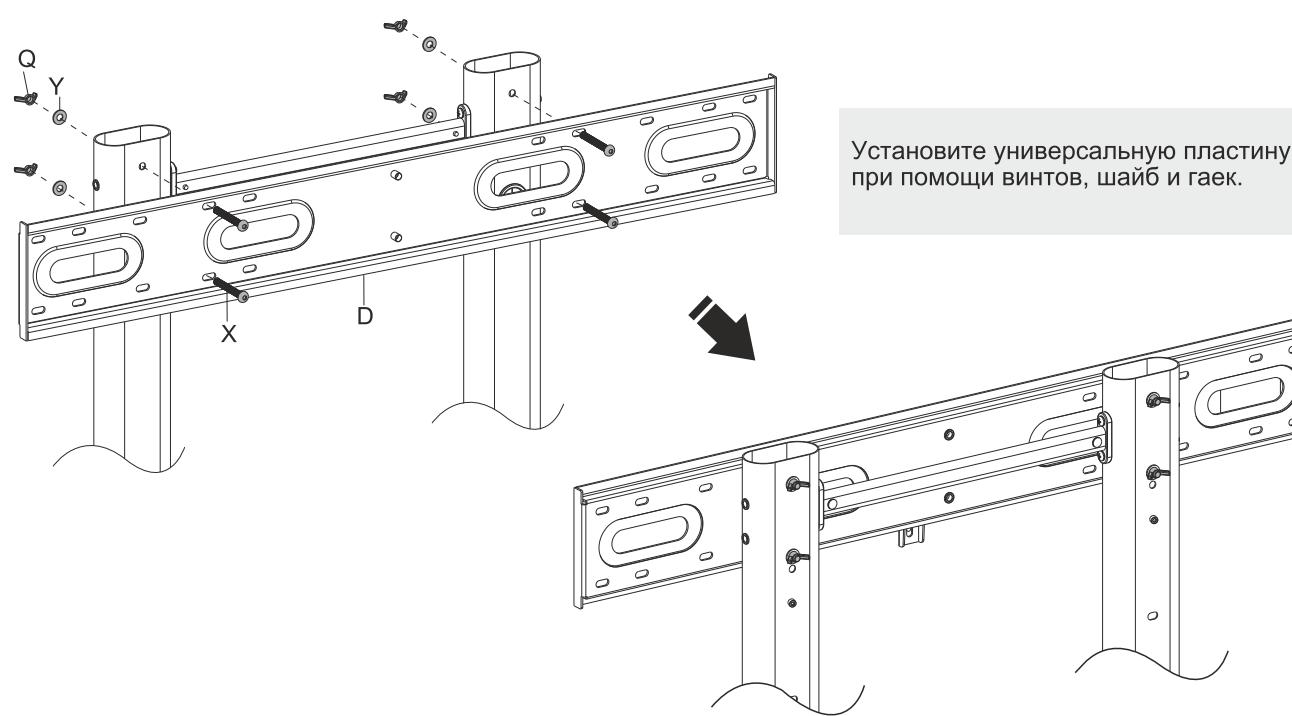
Установите универсальную пластину при помощи винтов, шайб и гаек.
