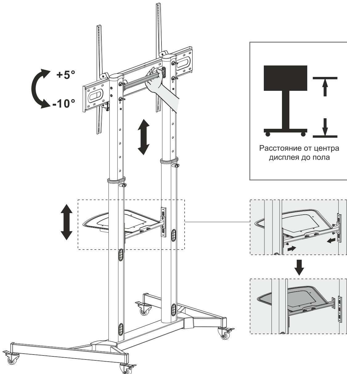
Внимание: Рекомендуем регулировать высоту стойки до установки на нее дисплея.
