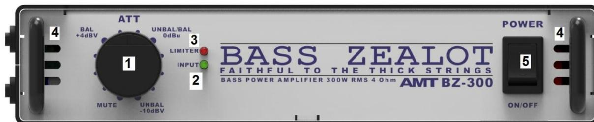
1. **INPUT SENSITIVITY** - аттенюатор входного сигнала, 12-ти позиционный переключатель. На панели отображены основные (стандартные) значения уровней входного сигнала и функция MUTE. Цена деления переключателя приблизительно 2dB.
