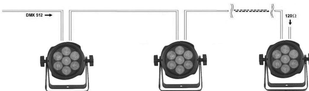
Utilizzare un cavo conforme alle specifiche EIA RS-485: bipolare intrecciato, schermato, 120Ohm di impedenza caratteristica e bassa capacità (SAGITTERSG DMX3 – SG DMX5).
