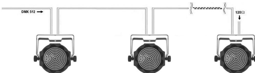
Utilizzare un cavo conforme alle specifiche EIA RS-485: bipolare intrecciato, schermato, 120Ohm di impedenza caratteristica e bassa capacità (PROEL DMXD – DMXD1).
