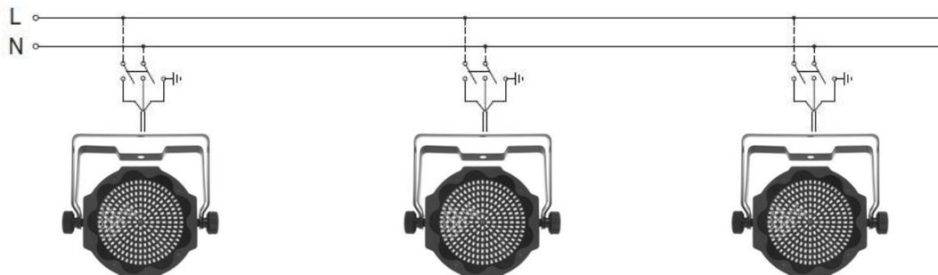
Il dispositivo deve essere collegato ad un sistema di alimentazione dotato di un'efficiente messa a terra. Inoltre, si consiglia di proteggere le linee di alimentazione dei prodotti dai contatti indiretti e/o da cortocircuiti verso massa utilizzando interruttori differenziali opportunamente dimensionati.
